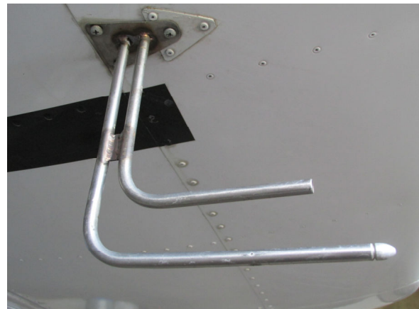
Fig. 2 : Tube de Pitot et port statique d'un Tecnam P2002JF
