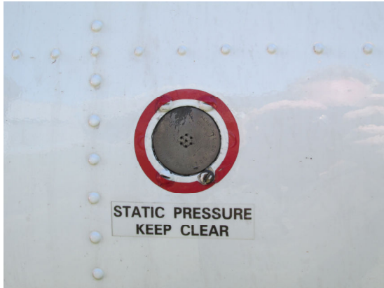
Fig. 3 : Port statique sur un PC7
